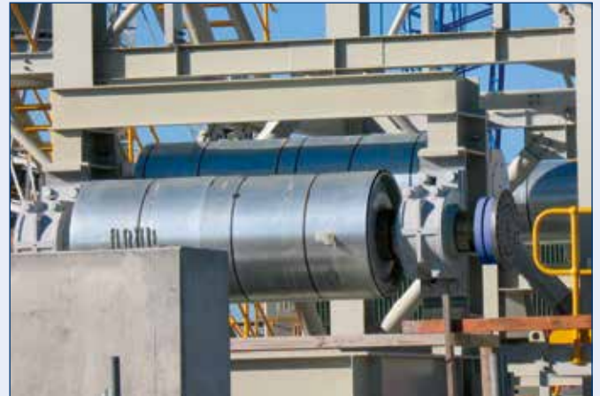
Bandtrommel mit Spannsätzen und einer Schrumpfscheibe auf der Antriebsseite Belt drum with Locking Assemblies and a shrink disc on the drive side
